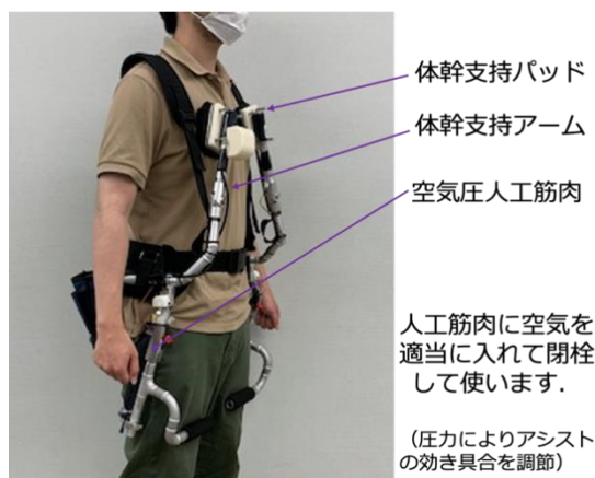
図 4-3 開発中の中腰アシスト装具
